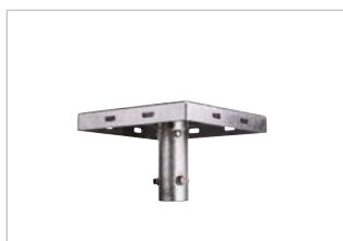
AKRON 4 60242 NEXT 2 - 3 - 4 - 6 - 8 - 12 Accessorio in acciaio zincato a caldo per montaggio n. 4 proiettori per pali Ø 76 mm max. Hot deep galvanized sheet steel accessory for max 4 floodlights, for pole max Ø 76 mm.
